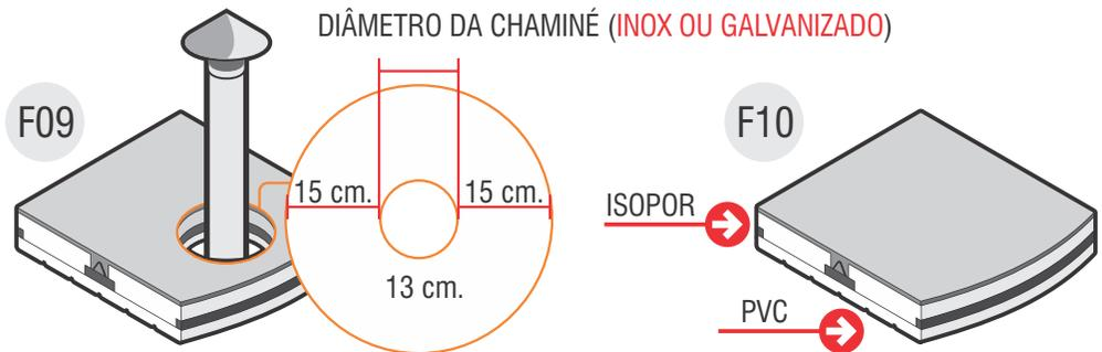
Após o corte deverá ser feito o isolamento térmico somente com aplicação de **lã de vidro** ou **massa refratária**, no preenchimento do espaço entre a chaminé e o corte na laje. (FIG 011)
