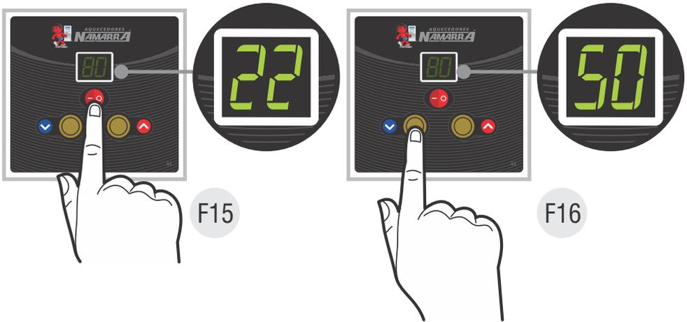
Com o segundo toque pode-se diminuir (FIG 24) ou aumentar (FIG 25) a temperatura seguindo o indicador.
