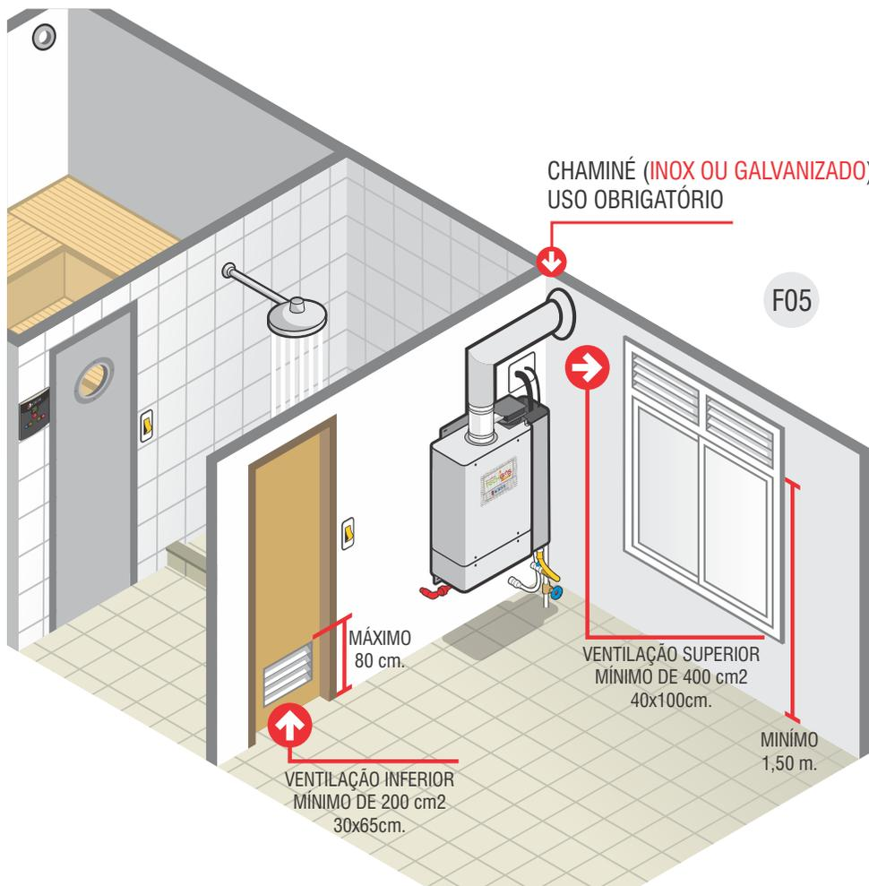
Faça a instalação da Mini Caldeira somente com mão de obra especializada. A aplicação da norma ABNT NBR 13.103 trata da forma adequada do uso da chaminé e da ventilação externa do ambiente.
